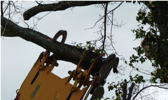
Démonstration d'un outil utilisé pour la taille des haies : le grappin coupeur. Crédit photo : Mission haies Auvergne
