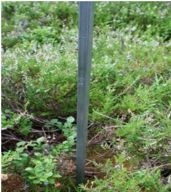
Tige métallique graduée permettant la mesure de hauteur de tourbe.
